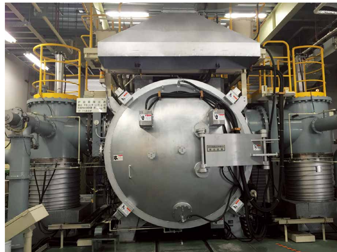
真空ろう付け炉。この炉の中に組み立てられたろう付け製品を投入する。
