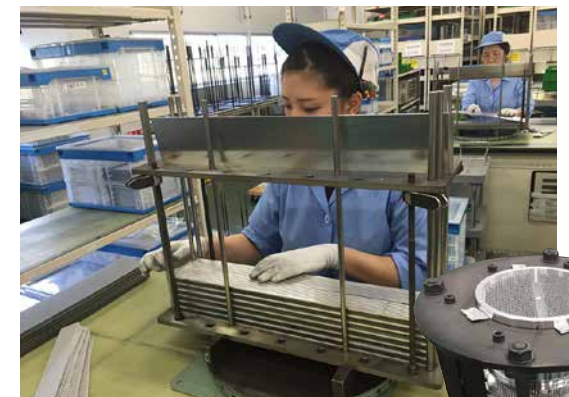
This heat exchanger adjusts temperature efficiently by means of fluids in grooves configured in a complicated design. The manufacturing process involves a high degree of craftsmanship. 熱制御のための重要部分。複雑な形状に作られた溝に油剤などを通すことで、効率的に温度を調整する。製造には緻密な手作業も必要とされる。
