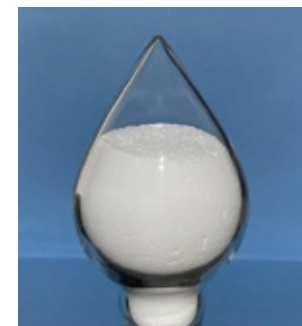
High-purity lithium compounds recovered from used LIBs 使用済みLIBから回収したリチウム結晶
