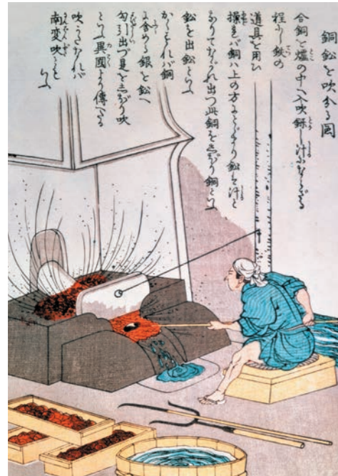
「鼓銅図録(住友家蔵版)」より 粗銅に含まれる銀や不純物を鉛を使用して取り除く 古式精錬法「南蛮吹(なんばんふき)」
