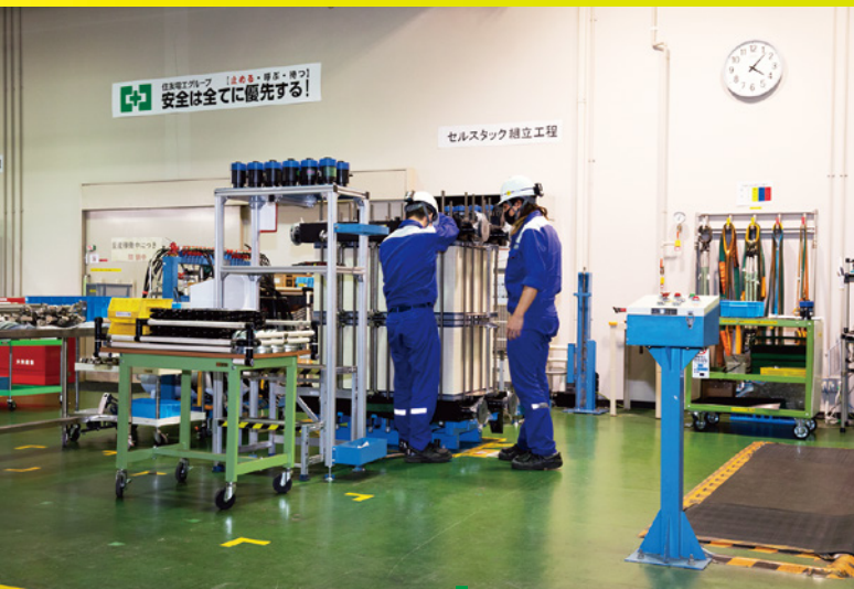
セルスタックの組み立て工程の様子。
