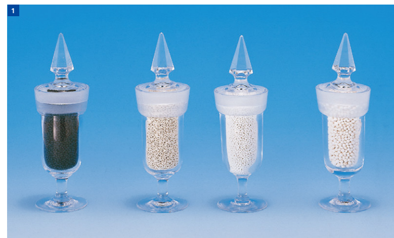
1. 様々な種類の吸着剤。PSAでは分離対象のガスに応じて、合成ゼオライトなど各種の吸着剤が使用される。 2. 肥料や機能化学品の製造から始まった住友精化は、ガス事業においてその独自性を発揮。コンパクトな装置から大規模設備まで、ユーザーの希望する製品をつくり込むことを強みとする。
