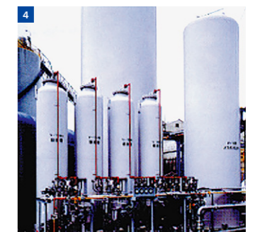
3. パッケージ型(99.999%水素100Nm 3 /h発生)メタノール改質高純度水素製造装置。半導体製造など高純度水素が必要な顧客に使用されている。 4. PSA水素ガス発生装置「H 2 -PSA」。メタノール分解ガスや天然ガスを分解して水素ガスを製造する。
