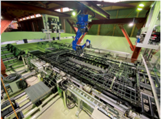
Robotaras rebar assembly automation system 鉄筋組立自動化システム「ロボタラス®」。
